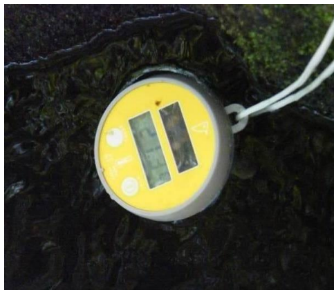
Figura 30 - Medição da temperatura da água.
